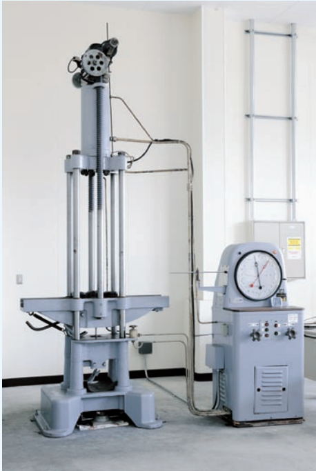
引張り強度試験
